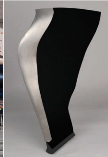
Carbon-fibre fan blade
